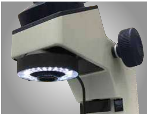
Lampă inelară LED pentru aplicații care necesită iluminare panoramică.
